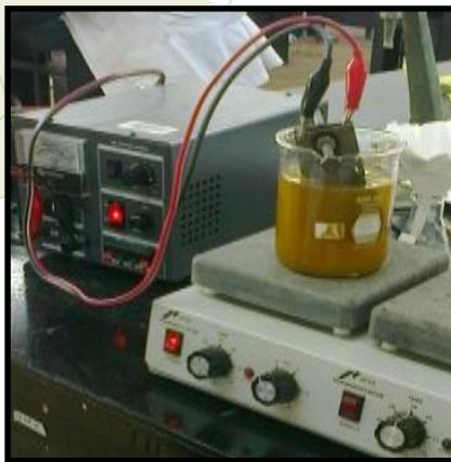
**Figura 1.** Aparato experimental para la electrocoagulación de cromo.
