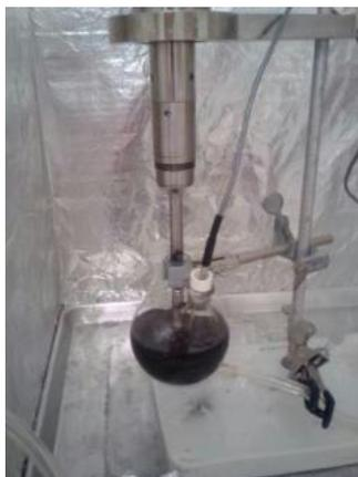
**Figura 1.** Primer método: utilizando el dedo ultrasónico.
